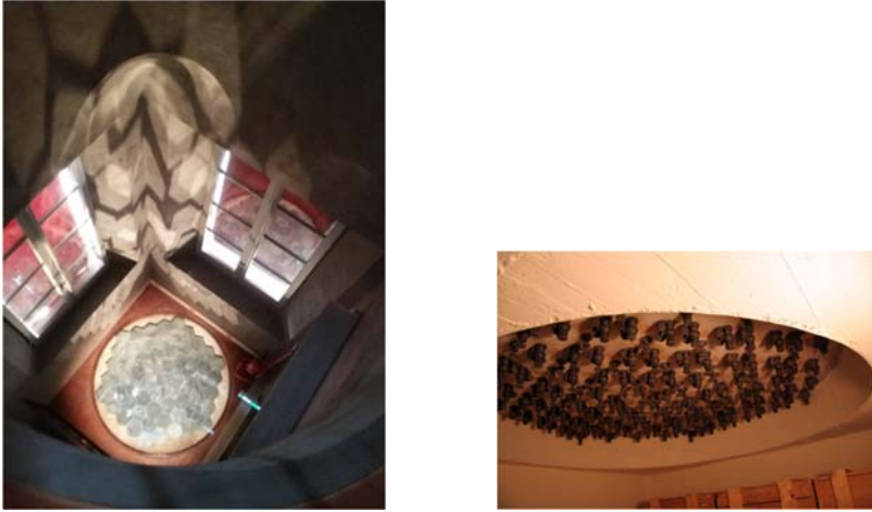
Fig. 4. A sinistra: lo specchio a tasselli oggi, ricollocato nella sua sede originaria e visitabile all'interno del percorso del Museo della Specola che occupa tutta l'antica torre. A destra: sul soffitto del piccolo locale, posto sotto allo specchio a tasselli da 1,80 m, si può vedere il complesso meccanismo di 183 viti che consentivano di regolare i 61 tasselli (foto: F. Bònoli).
