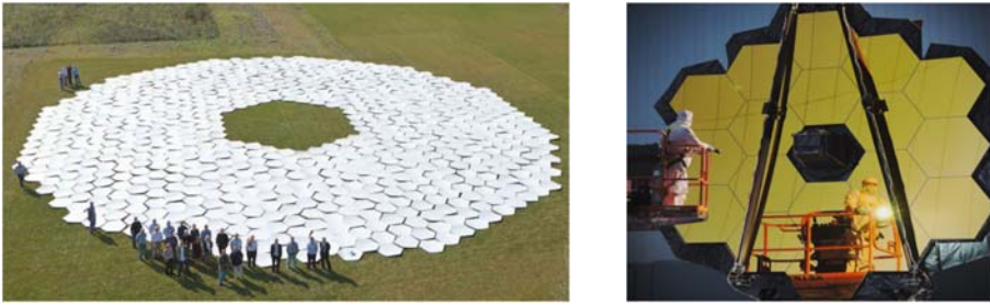
Fig. 5. A sinistra: ricostruzione simulata dello European Extremely Large Telescope dell'ESO, in costruzione in Cile, composto da 798 esagoni da 1,45 m ognuno, per un diametro totale di 39,3 m (foto: ESO). A destra: il James Webb Space Telescope , oramai praticamente terminato, è composto da 18 specchi esagonali per 6,5 m complessivi (foto: NASA/JPL). In entrambi i casi è impressionante la somiglianza con lo specchio a tasselli di Hd'A.
