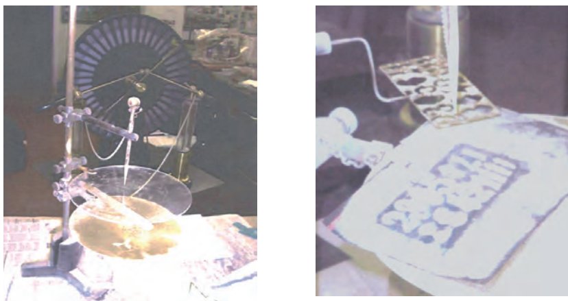
Figg. 17-18. A sinistra, apparato con il disco coibente in plexiglas distanziato dal disco conduttore d'ottone; a destra, ombra di numeri di ottone con zolfo su carta nera appoggiata a disco metallico
