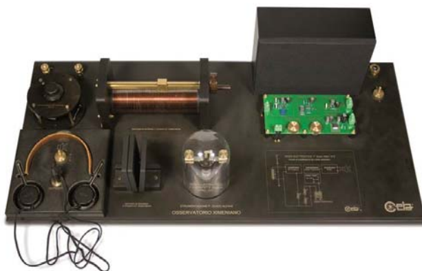
Fig. 4. Radioricevitore costruito nel 1912, il cui schema è nel libretto che Padre Alfani volle dedicare a Marconi, in occasione della sua visita nel 1912 (Calamia, Manneschi 2011, p. 27). Il diodo, la cuffia e il condensatore sono quelli originali.
