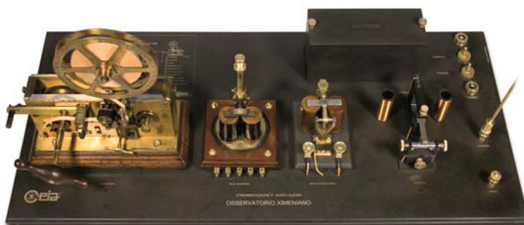
Fig. 5. Radioricevitore costruito nel 1923 secondo lo schema del ricevitore di Marconi del 1895 (Calamia, Manneschi 2011, p. 29). Salvo la scatola delle batterie, gli altri pezzi, fra i quali il coherer (in basso a destra, vicino all'antenna), sono originali.
