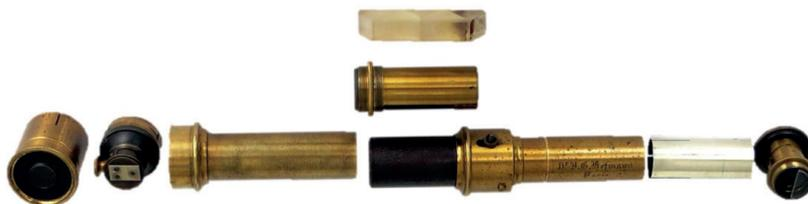
**Fig. 4.** Lo strumento scomposto nelle sue parti principali: si notano la fenditura, il collimatore (spoglio del rivestimento in pelle), il gruppo formato dai cinque prismi (in alto) e l'ottica di osservazione con l'oculare Ramsden munito di scala graduata; sui due prismi di vetro flint è graffiata la data 1876.
